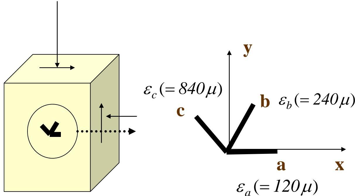
Strain gage a,b,c 分別與水平夾  $\theta_a, \theta_b, \theta_c (= 0^\circ, 60^\circ, 120^\circ)$
